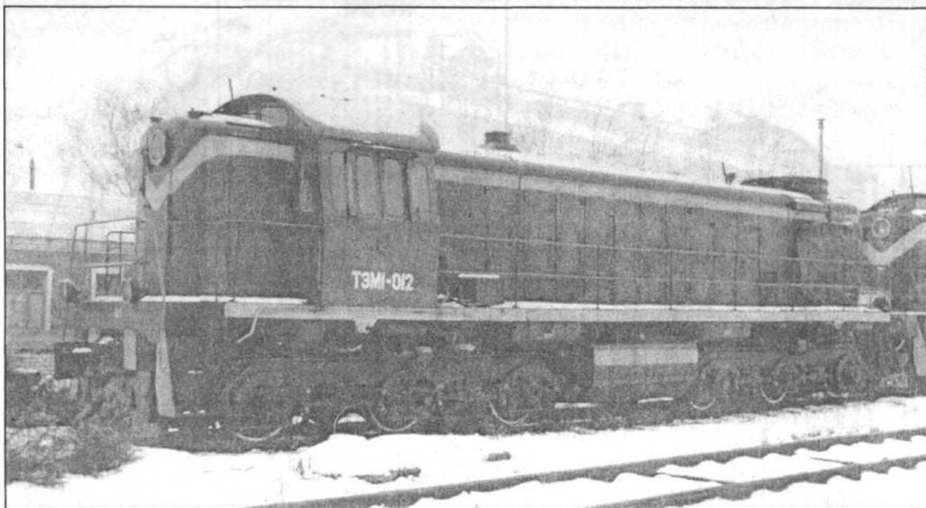
Тепловоз ТЭМ1-012 первого выпуска имеет скошенную кабину. Фото Юрия Акимова в депо Брянск-1 в январе 1998 г. К этому времени тепловоз уже лишился буферов и звезды на лобовой части капота.
