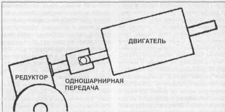
Рисунок 3. Вариант одношарнирной передачи. Применяется редко, т.к. почти не имеет продольно-компенсирующих свойств и накладывает серьезные требования к совпадению осей качания механизмов и осей сферы.
