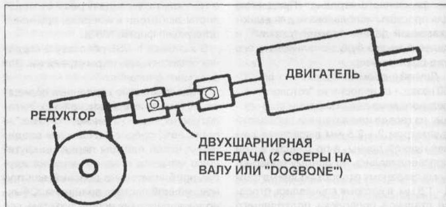
Рисунок 4. Вариант двухшарнирной передачи. Применяется часто благодаря менее жестким требованиям к точности и хорошим компенсирующим свойствам.
