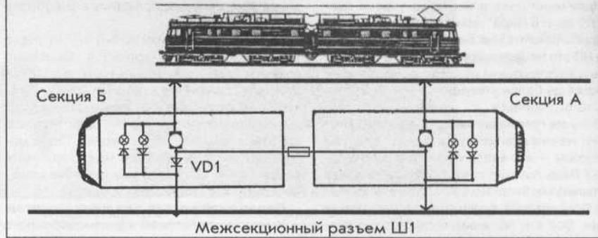
Схема 1.2. Схема коммутации мотора и огней для переключения режимов "Один локомотив" - СМЕ
