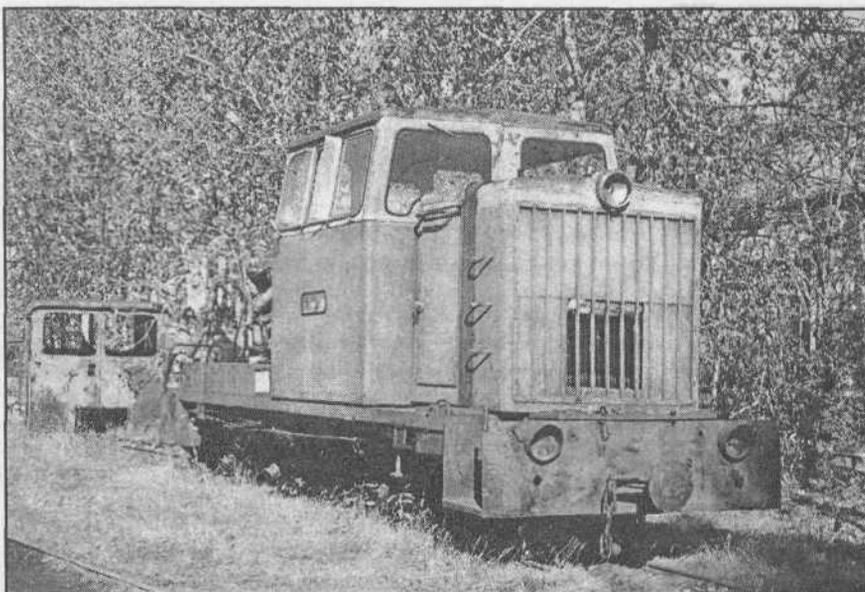
Тепловоз ТУ6Д-0142, 2000г. Установлен двигатель ЯМЗ-236, поэтому удлинен капот и срезаны поручни передней площадки. Фото А.Корсакова
