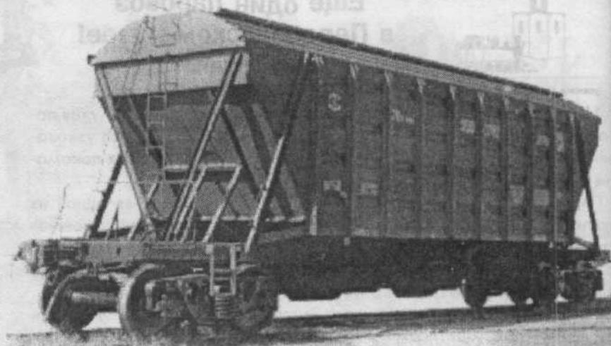
*Хоппер для зерна грузоподъемностью 72 т постройки Крюковского вагонзавода, модель 19-752, 1975 г.*
