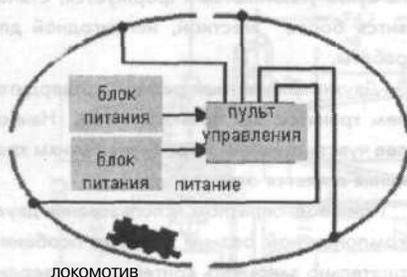
Блок-схема аналогового управления (слева) и цифрового управления (справа)
