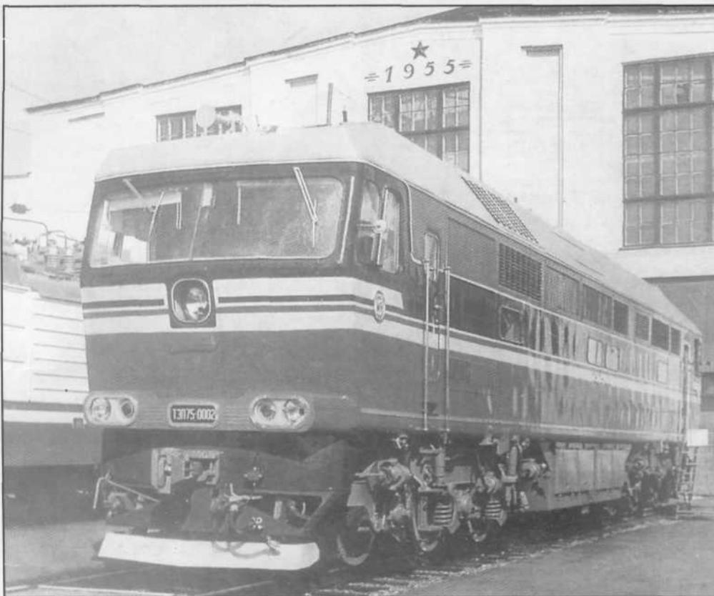
В 1977 году Коломенский тепловозостроительный завод выпустил тепловоз ТЭП75-0002. Испытания тепловоза ТЭП75 показали, что он имеет слишком большой вес для нормальной работы пассажирского тепловоза. В 1979 году локомотивы были переданы для опытной эксплуатации на Октябрьскую железную дорогу, где в дальнейшем проводился ряд исследований работы различных систем и оборудования, однако дальнейшие конструкторско-проектные работы по ним были прекращены. Фото из архива.
