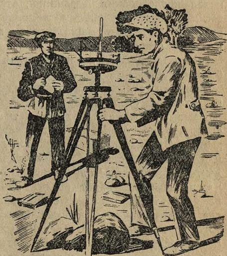
Наблюдение дефлекторным магнитометром
