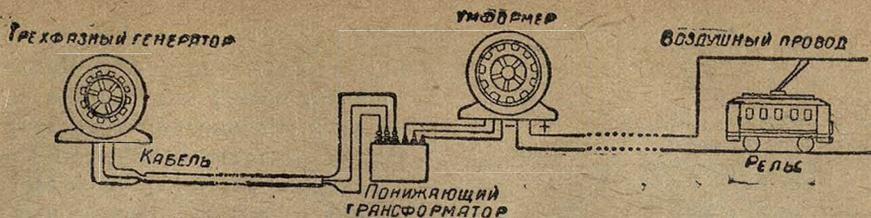
Рис. 4. Схема питания трамвая токoм через подстанции. От генератора на центральной станции трехфазный ток высокого напряжения идет на подстанции, там трансформируется на низкое напряжение и превращается в постоянный, затем направляется на линии
