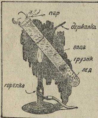
На этом и основан опыт, изображенный на нашем рисунке. В пробирке, нагреваемой сверху, вода в поверхностных слоях уже кипит; на дне же пробирки она еще так холодна, что удерживаемый там (свинцовой пулькой) кусочек льда не тает. Этот опыт легко проделать на обыкновенной свечке.
