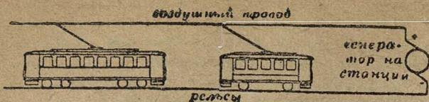
Рис. 1. Простейшая схема питания трамвая ток. Ток от генератора на станции направляется в воздушный провод, затем проходит через моторы на валик и по рельсам возвращается на станцию
