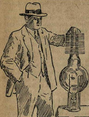
Самоубийственный предел для лампы Эдисона: лампа в 50.000 свечей, снабженная мощным охладителем.
