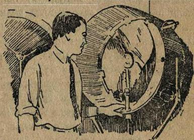
„Беспроволочный“ проектор на 100.000 свечей. Лампа состоит из стеклянного шарика (в фокусе зеркала) с разреженным газом внутри, и .. больше ничего.
