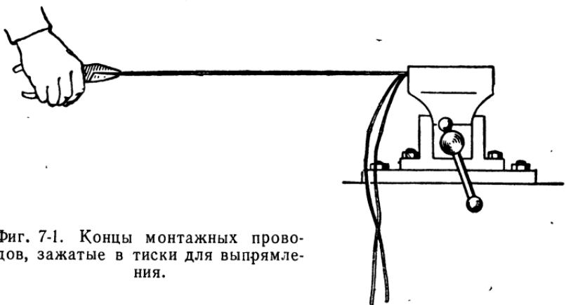
Фиг. 7-1. Концы монтажных проводов, зажатые в тиски для выпрямления.
