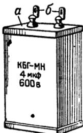
Фиг. 3-19. Конструкция конденсатора КБГ-МН.
