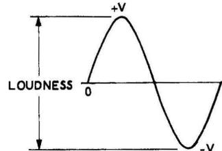
THE LARGER THE ELECTRICAL SIGNAL IS IN VOLTS... THE LOUDER THE SOUND WILL BE IN THE SPEAKER.
